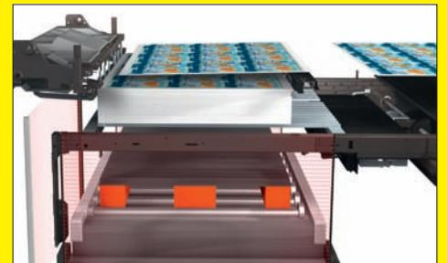
Die Neuheiten, die Heidelberg zur Ipex angekündigt hat, sind vor allem Verbesserungen im Detail zur Steigerung von Produktionsgeschwindigkeit und -sicherheit. Für die Speedmaster XL 105 beispielsweise hat der Druckmaschinenbauer einen automatischen Non-Stop-Ausleger entwickelt (siehe Bild). Der Stapelwechsel im Ausleger kommt dadurch ohne Bediener aus. Seite 22
